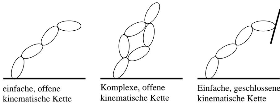
Abbildung 2.9: Beispiele für verschiedene aktive Mechanismen.
